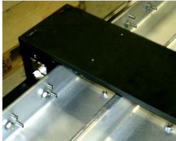
Fig. 4 Ställskruvar för kalibrering
