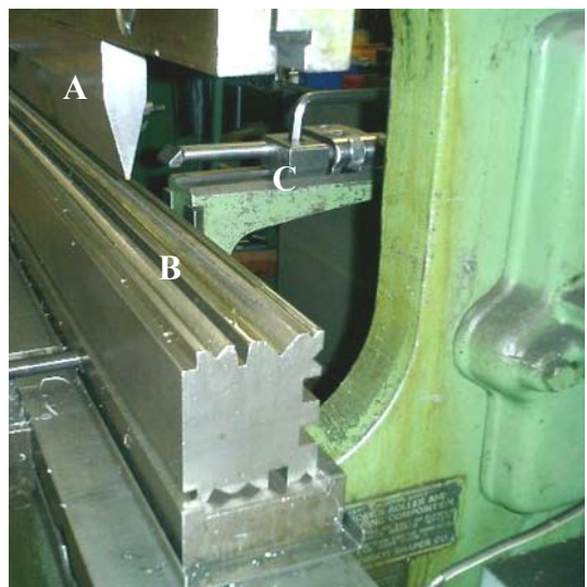
Fig. 2 Kniv A, dyna B, stopp C
